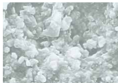
REM-Aufnahme der Oberfläche des Vergleichsproduktes
